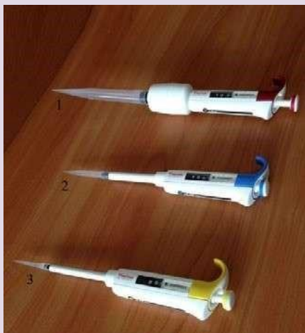
Рис. 5 Пипетки дозаторы одноканальные переменного объёма: 1 — 110 мкл; 2 — 100—1000 мкл; 3 — 10—100 мкл.
